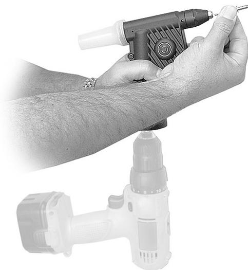
5. Переключите кнопку реверса в режим правого вращения и нажмите **«пуск»**. Удерживайте кнопку до характерного щелчка, означающего установку заклепки и отрезания **«хвоста»**.
