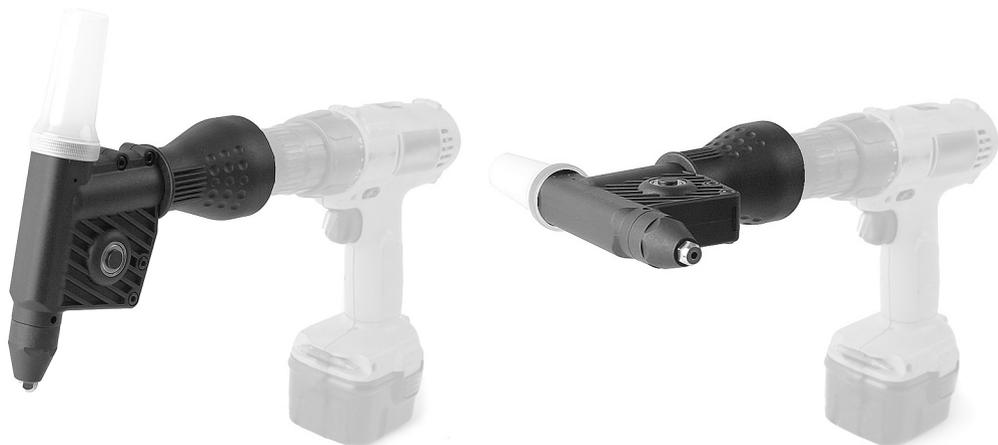
2. Установите на заклепочник насадку с диаметром, соответствующим Вашим заклепкам. Хвостовик заклепки должен свободно входить в отверстие насадки.
