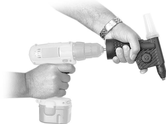
4. После выключения заклепочника установите заклепку в насадку и вставьте ее в отверстие скрепляемых материалов.
